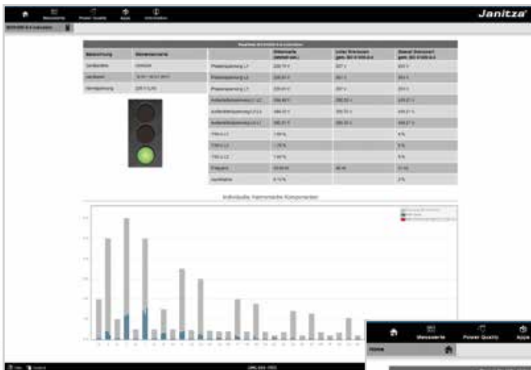
Abb.: IEC 61000-2-4 Analyse mit Ampelprinzip
