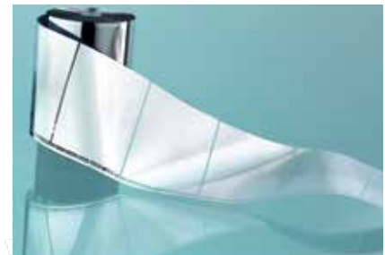
Abb.: Selbstheilende, segmentierte Kondensatorfolie
