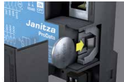
Abb.: Leichtes Austauschen der Batterie während des Betriebs
