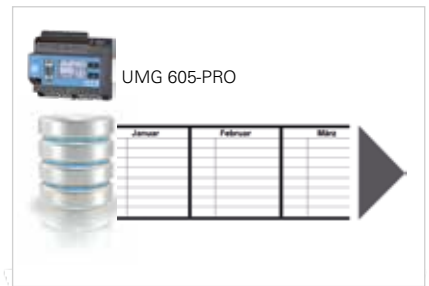
Abb.: Großer Messdatenspeicher
